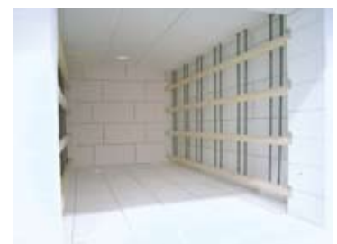
Griglia di protezione davanti agli elementi riscaldanti per la protezione da danni meccanici
