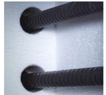
Vano forno in materiale in fibra pregiato e barre di riscaldamento di SiC ai lati del forno
