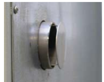
Apertura per l'aria di scarico sulla parete posteriore per la fuoriuscita dei gas combustibili derivanti dall'essiccazione
