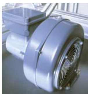
Ventole collegate con una valvola di scarico automatica per ridurre i tempi di raffreddamento
