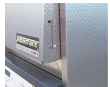
Valvola a regolazione continua per la presa d'aria
