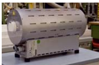
Forno tubolare con regolazione a cinque zone per una distribuzione particolarmente uniforme della temperatura
