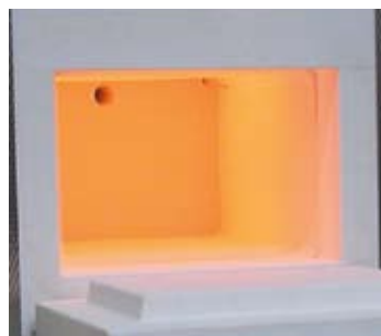
Riscaldamento della muffola da 4 lati
