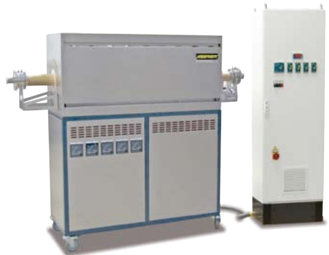
RHTH 80-1000/16-5 con regolazione della temperatura a 5 zone come forno a gradiente
