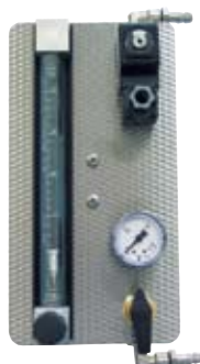
Pannello del gas per gas protettivo non infiammabile con rubinetto di chiusura e misuratore di scorrimento con valvola regolabile, dotato di tubatura pronta per l'attacco
