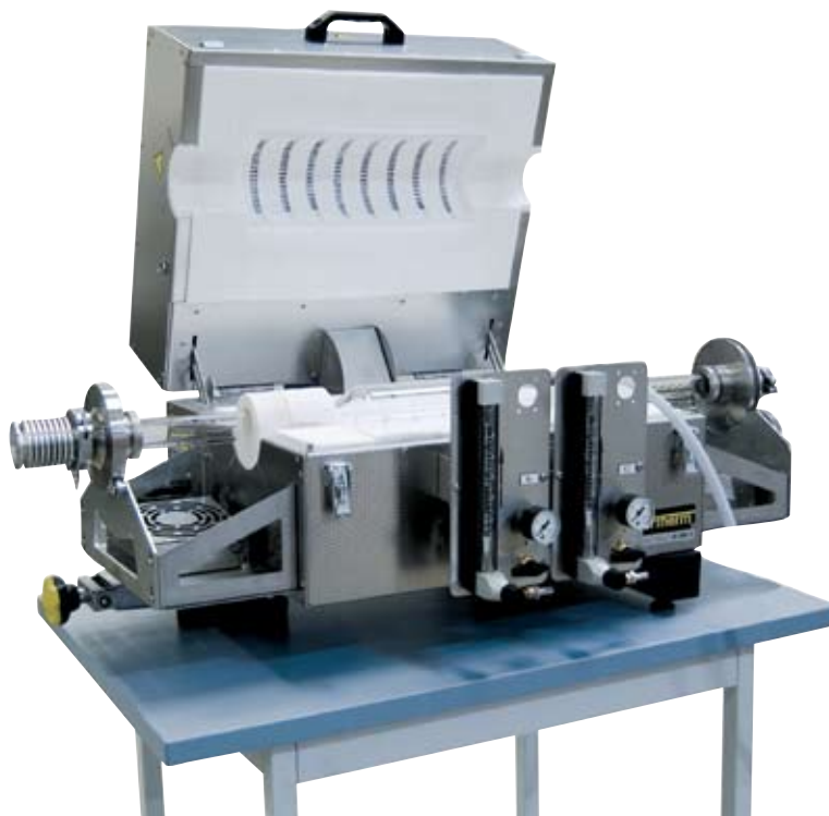
RSR 80-300/11 in versione ribaltabile con reattore in vetro e funzionamento sotto gas inerte
