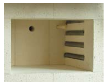
Vano forno con isolamento resistente in mattoni refrattari leggeri
