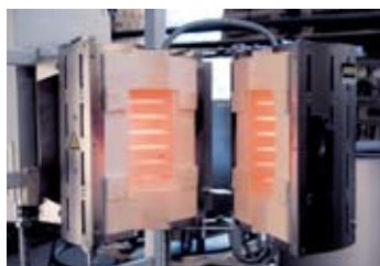
RS 100-250/11S in versione apribile, installabile in un'attrezzatura di prova
