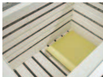
Camera di cottura con riscaldamento su cinque lati
