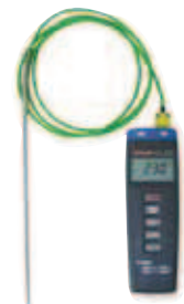
Misuratore della temperatura per RAKU 100, di facile uso, termorivelatore NiCr-Ni, visualizzazione valori da 20 a 1200 °C, possibilità di collegamento per un secondo rivelatore con commutazione della visualizzazione
