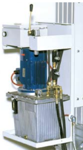
Azionamento elettroidraulico della campana come nel modello standard
