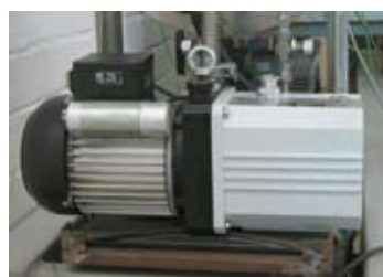
Pompa a vuoto per la depurazione della storta a freddo
