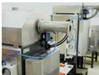
Scarico del gas con valvola a motore
