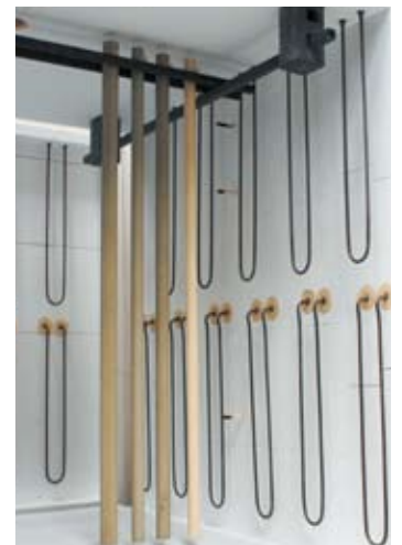
Caricamento in sospensione del forno mediante tubi di ceramica
