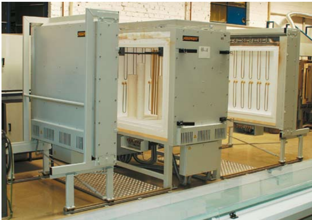
HT 1000/17 con 2 porte e riscaldamento continuo per la sinterizzazione di tubi di ceramica in sospensione fino a 1700 °C
