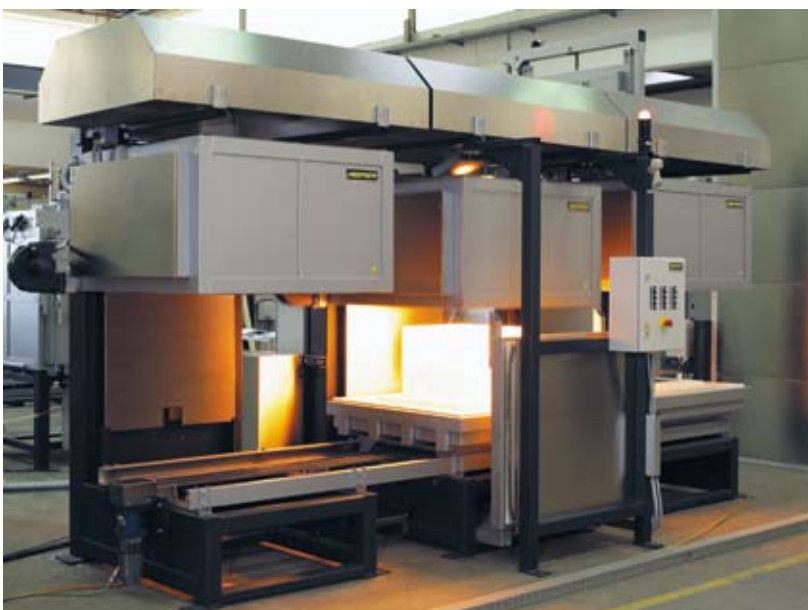
Impianto con campana per la sinterizzazione della ceramica tecnica con due stazioni di raffreddamento per il funzionamento completamente automatico
