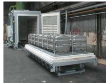
Camere ad atmosfera controllata sulla suola mobile per il forno W 14850
