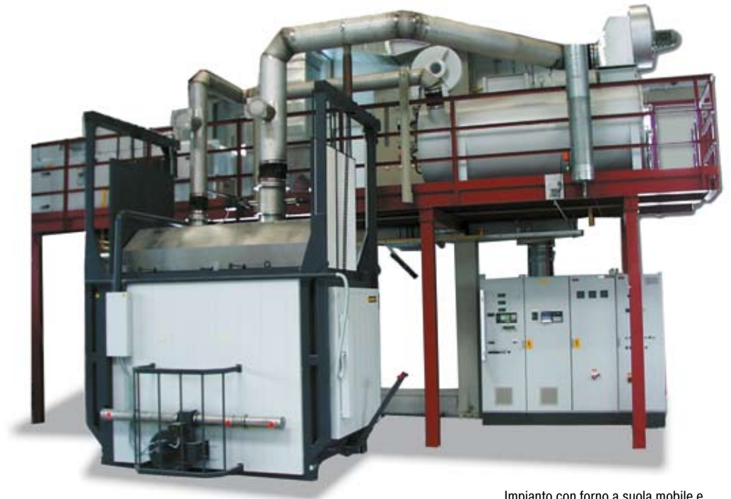
Impianto con forno a suola mobile e postcombustione termica integrata per la depurazione dell'aria di scarico
