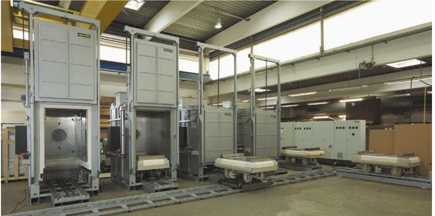
Impianto con suola mobile completamente automatico dotato di dispositivo di smistamento trasversale e cambio di carrello automatico
