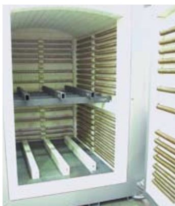
N1500/H con struttura integrata a barre in SiC
