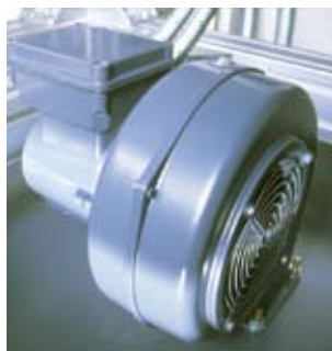
Ventola di raffreddamento collegata con una valvola di scarico automatica per ridurre i tempi di raffreddamento
