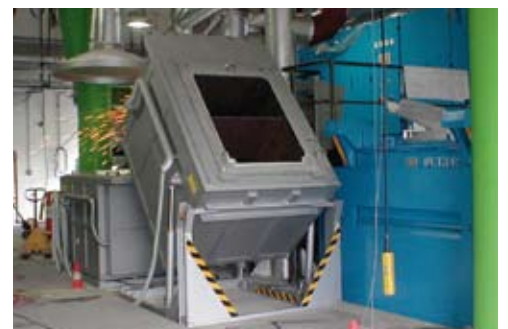
Forno a crogiolo ribaltabile per magnesio K 1500/75 S con capienza crogiolo di 1500 litri
