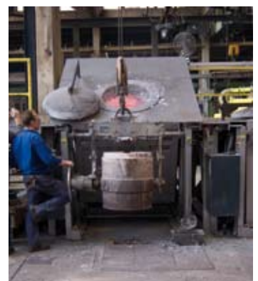
Riempimento della siviera di trasporto con un K 360/12
