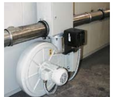
Ventola di raffreddamento per accelerare i tempi di processo
