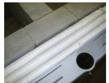
Mattoni speciali nel vano forno, isolamento posteriore multistrato
