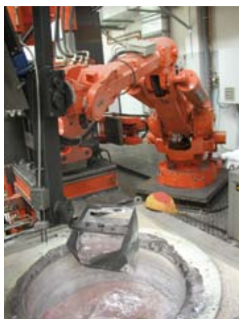
Prelievo da un T 650/10 con un robot
