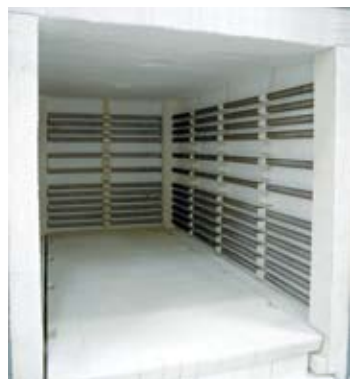
Isolamento in fibra pregiata con pietre angolari murate per tempi di raffreddamento e riscaldamento più brevi
