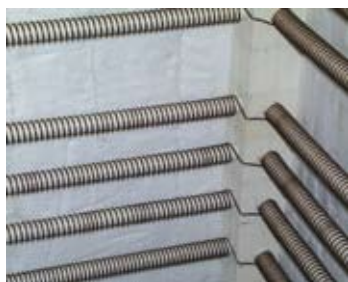
Isolamento delle pareti laterali con materiale in fibra per i modelli KF
