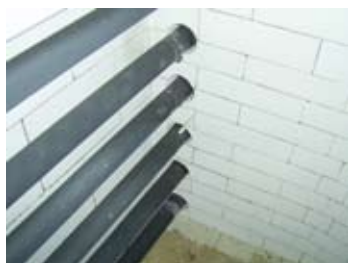
Riscaldamento da entrambi i lati attraverso potenti barre SiC
