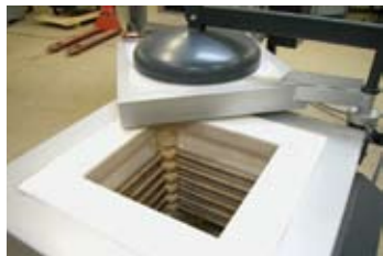
Piastra con collare di un forno a crogiolo elettrico, orientabile verso il lato per tirare il crogiolo
