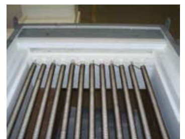
Riscaldamento dal coperchio, sostituzione facile degli elementi riscaldanti
