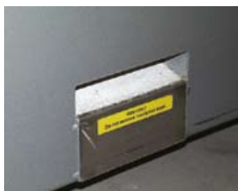
Scarico d'emergenza per uno scarico sicuro del materiale fuso in caso di rottura del crogiolo
