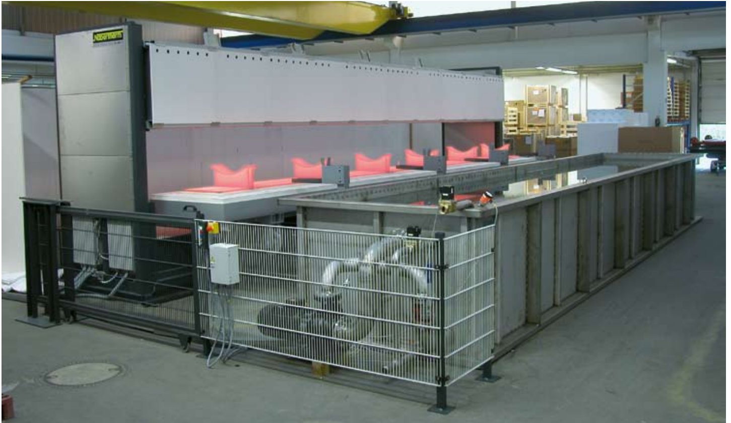
Impianto di bonifica con forno a campana H 4263/12S e bagno di acqua
