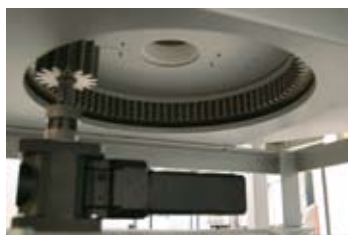
Azionamento con corona dentata sotto il forno
