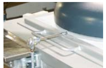
Regolazione del bagno di fusione con termocoppia nel materiale fuso
