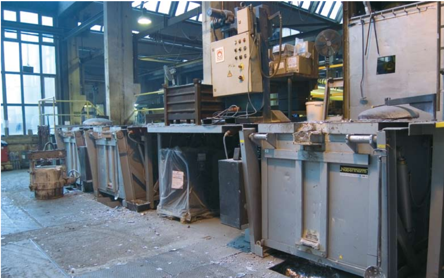
3 x K 300/12 con piattaforma di caricamento per la fusione di alluminio
