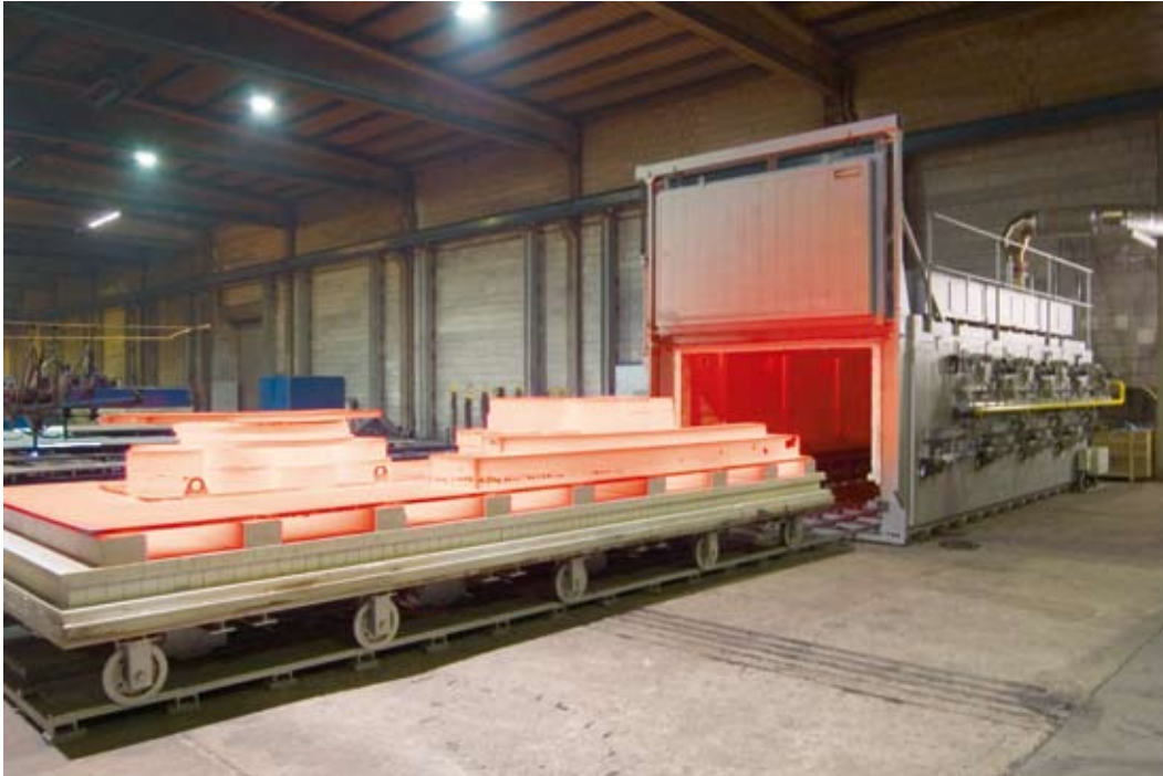
Forno a suola mobile riscaldato a gas WB 14880 S per la ricottura di grossi pezzi di acciaio
