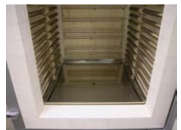
Vasca di scarico sul fondo
