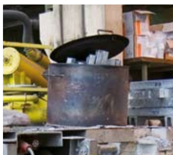
Attrezzatura di caricamento per lingotti
