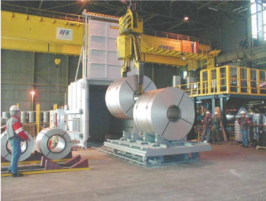
Forno a suola mobile W 21875/26AS in versione personalizzata per il preriscaldamento di bobine di lamiera con un peso di carica complessivo fino a 50 t
