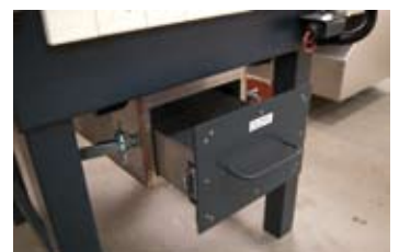
Cassetto per la raccolta della cera liquida
