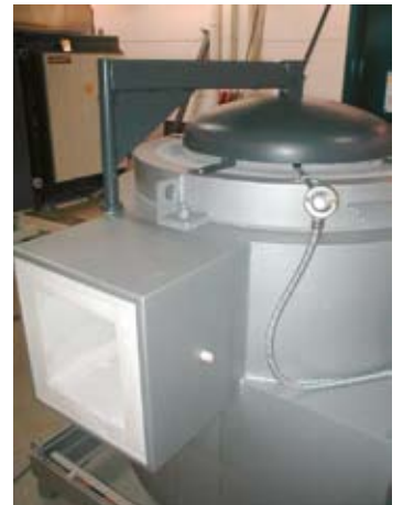
TB 80/12 con scarico gas laterale
