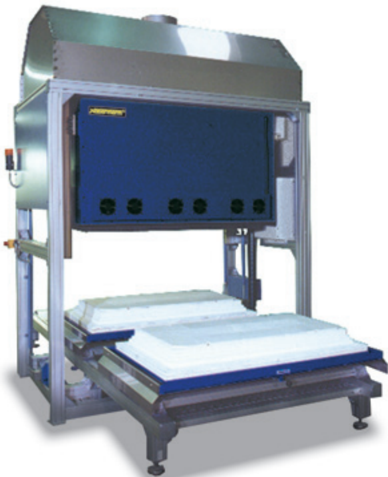
Forno a campana HT 400/17 LTS con sistema a tavola intercambiabile optional
