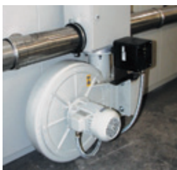
Sistemi di raffreddamento per abbreviare i tempi di processo disponibili come optional
