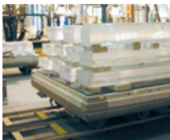
Forno a suola mobile realizzato in versione personalizzata per la malleabilizzazione di barre in quarzo opalino
