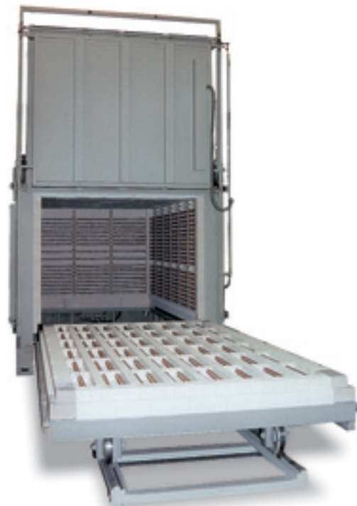
Forno a suola mobile W 15000/S in versione realizzata su misura. Porta sollevabile ad azionamento elettroidraulico e bacino scorrevole su rotaie optional
