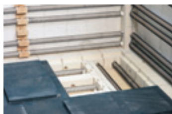
Riscaldamento del fondo coperto da piastre in carburo di silicio superficie d'appoggio piana per l'impilamento del materiale
