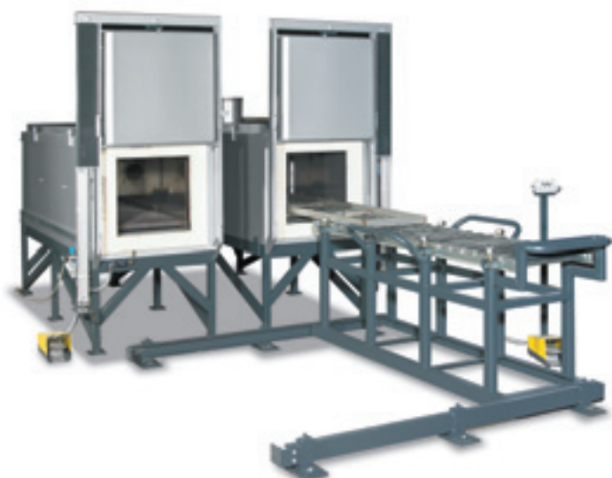
Rulliera antistante due forni a convezione per il caricamento del materiale all'interno di essi ed il trasferimento del vetro da un forno all'altro. Possibilità di integrazione di soluzioni aggiuntive per l'automatizzazione del processo.
