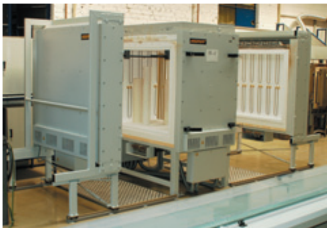
Forno ad alta temperatura divisibile HT 1000/17S per la sinterizzazione di tubi e vetro di quarzo
