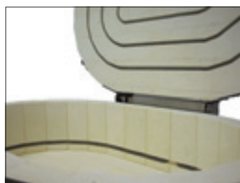
Vano interno con riscaldamento dell'anello laterale inferiore
