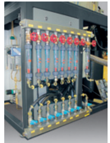
Alimentazione acqua di raffreddamento
