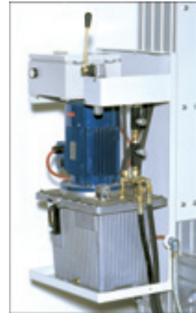
Azionamento elettroidraulico della campana di serie
