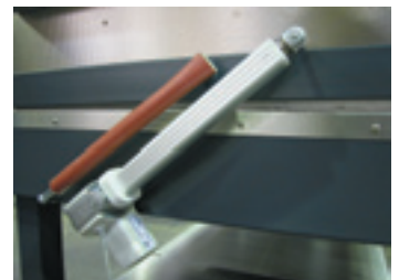
Apertura automatica del coperchio tramite asta meccanica
