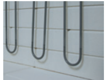
Vano forno con robusto isolamento in mattoni refrattari leggeri al posto di quello in fibra per l'esecuzione di prove di fusione in laboratorio
