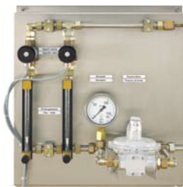
Sistema di gasaggio automatico per due quantità di lavaggio
