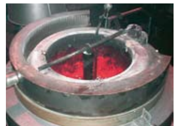
Aspirazione dei gas di scarico al bordo del crogiolo
