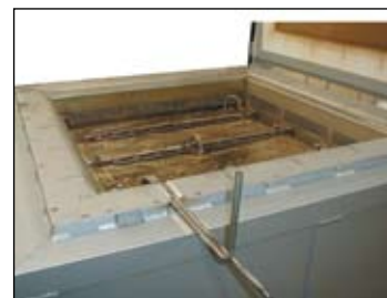
Forno a pozzo S 250/65A con cassetta di gasaggio per la ricottura in bianco
