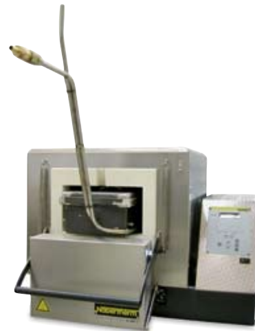
N 11 con cassetta di gasaggio
