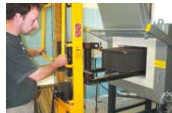
Carrello di caricamento con cassetta di gasaggio e forno
