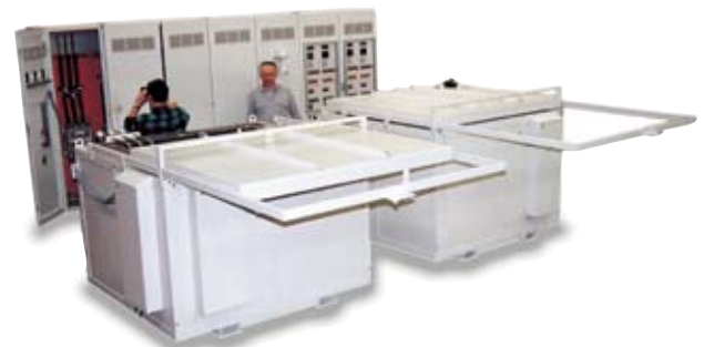
Impianto a bagno di sale per ricottura di componenti in alluminio per l'industria aeronautica
