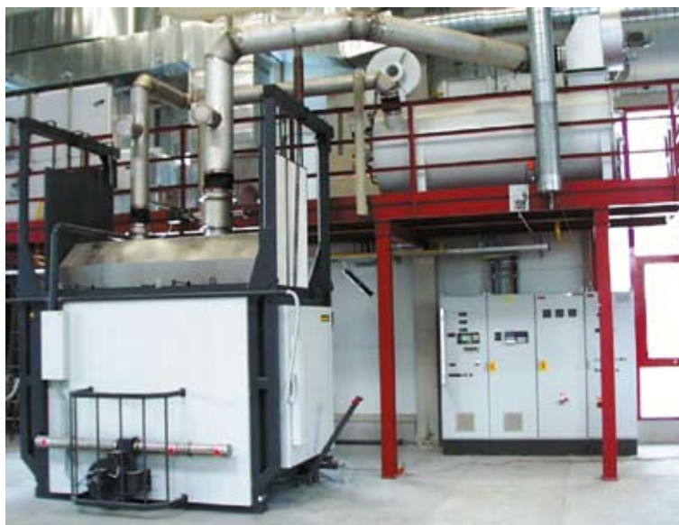
Impianto a più forni con post-combustione termica integrata per la depurazione dell'aria di scarico e sistema di sicurezza.
