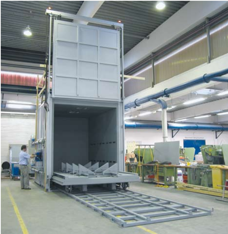
Forno a suola mobile con dispositivo di alloggiamento per carichi cilindrici
