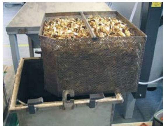
Ricottura in bianco di materiale sfuso all'interno di una cassetta di ricottura con cesto di estrazione
