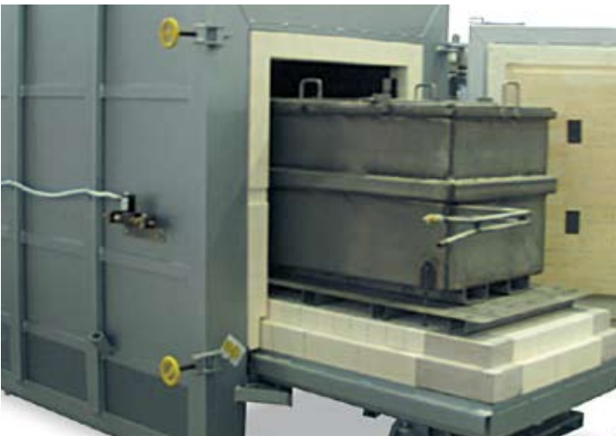
Cassetta a gas inerte utilizzabile in un forno a suola mobile con circolazione d'aria
