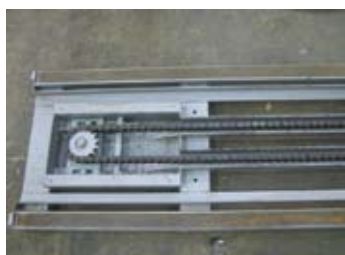
Azionamento con alimentatore a catena motorizzato come dotazione speciale
