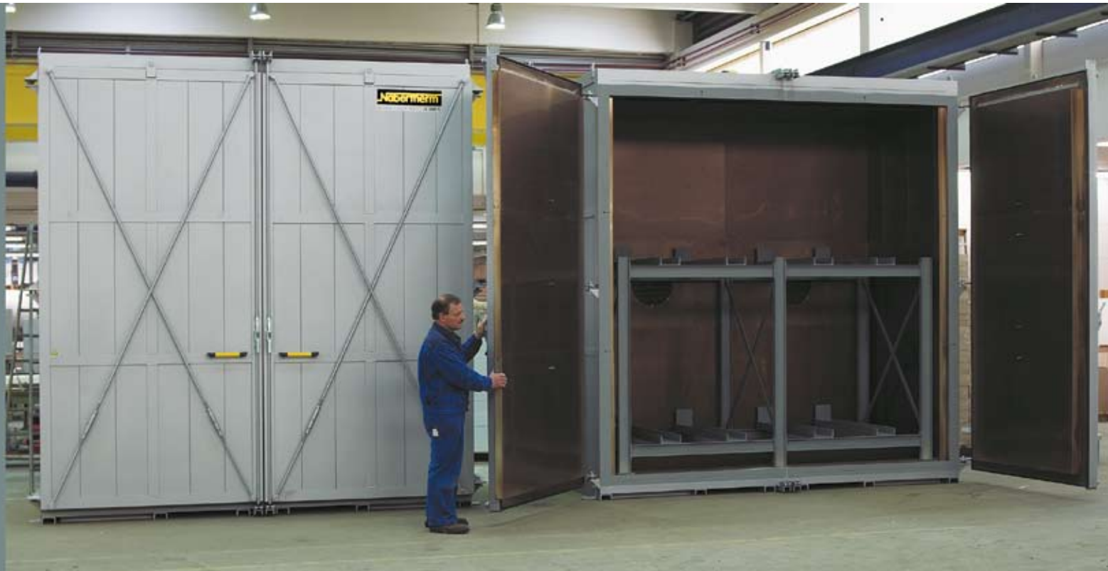
2 x N 12000/26AS con telai di caricamento per il periscaldamento di stampi
