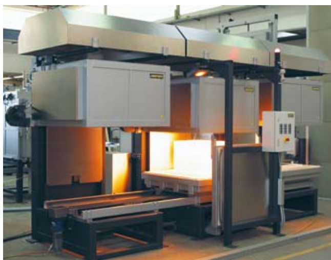
Forni a campana H 245/LT con stazione di raffreddamento e sistema a tavola intercambiabile completamente automatico. Combinazione di processo di ricottura, raffreddamento rapido ad aria e rinvenimento in un unico impianto. L'esecuzione completamente automatica viene controllata, monitorata e documentata tramite il Control Center NCC di Nabertherm (vedi pagina 38).
