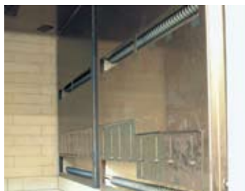
Convezione verticale dell'aria con scarico dell'aria dalle fiancate del forno
