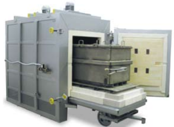
Forno a suola mobile a convezione con cassetta per ricottura a gas inerte (vedi pagg. 22,23).
