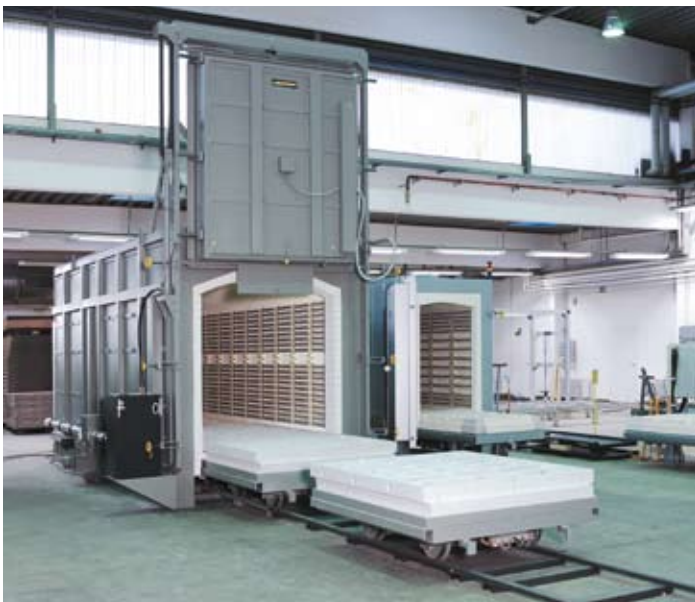
W 10800/HS1 è dotato di carrello suddiviso per un agevole spostamento di carichi elevati
