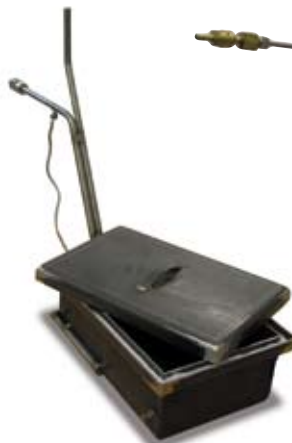
Cassetta di ricottura con ingresso e uscita per gas inerte
