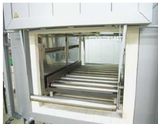
Forno a camera dotato di 2 porte, rulliera all'interno e al di sotto delle porte sollevabili per agevolare lo scarico del forno. Il caricamento si effettua davanti e dietro.
