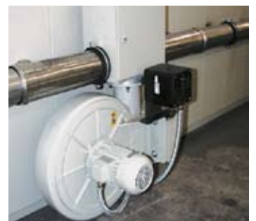
Ventola di raffreddamento per accorciare i tempi di processo
