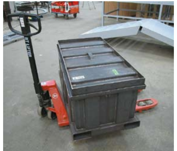
Cassetta di dimensioni adatte al caricamento con elevatore a forche
