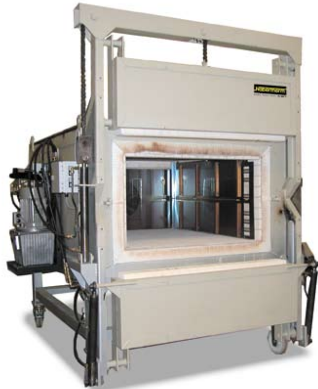
Forno di ricottura con porta a sollevamento elettroidraulico e basamento mobile per il preriscaldamento di componenti in lamiera di grandi dimensioni per l'industria automobilistica
