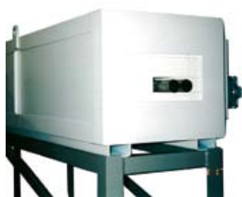
Forno continuo con due tubi riscaldati per la ricottura di piattine
