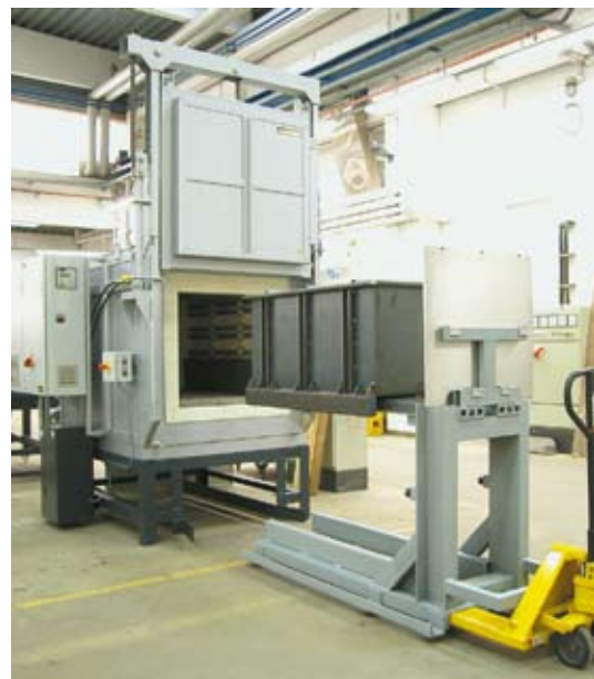
Dispositivo di caricamento con scudo termico per cassetta di ricottura
