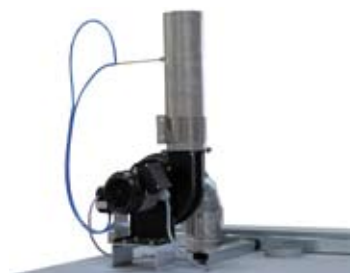
Apertura di presa d'aria e potente ventola per l'aria di scarico montate sul forno
