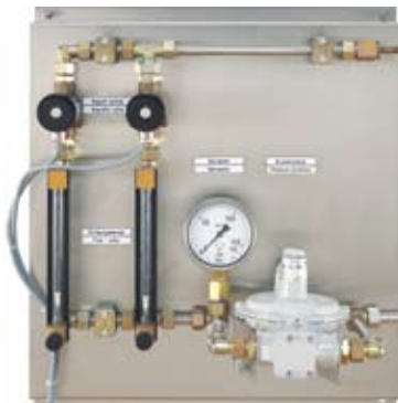
Dispositivo erogazione del gas automatico per cassette di ricottura
