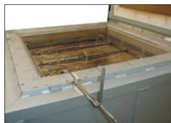
Forno a pozzo S 250/65A con storta a gas inerte per ricottura in bianco (vedi pag. 14)
