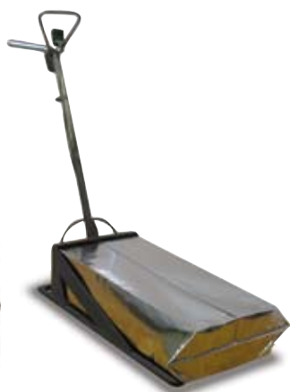
Sacchetto di ricottura con supporto e apertura d'entrata per il gas inerte
