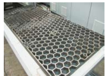
Griglia d'acciaio sul carrello del forno a suola mobile per il caricamento di carichi elevati
