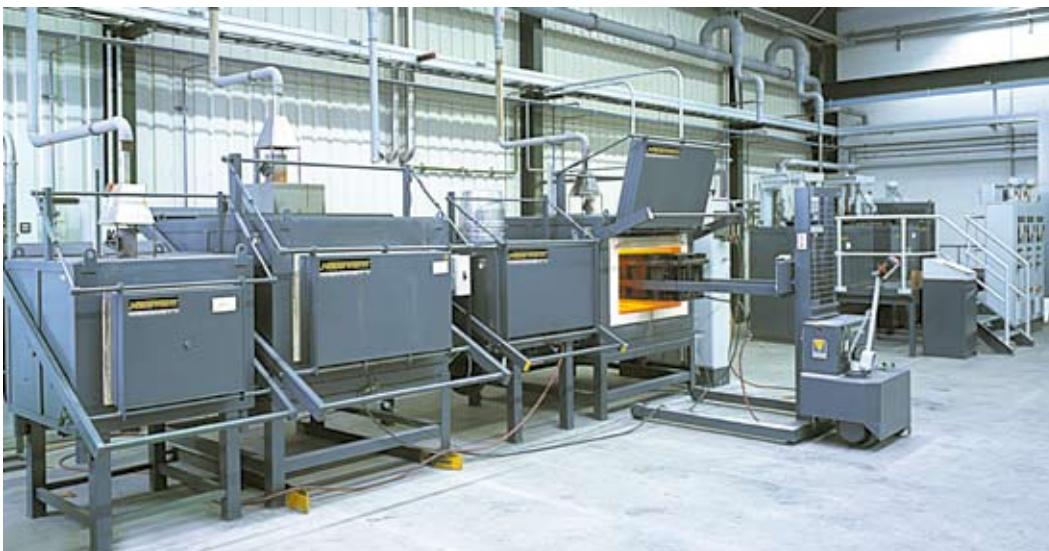
Impianto a più forni, costituito da 4 x N 321/S con dispositivo di caricamento
