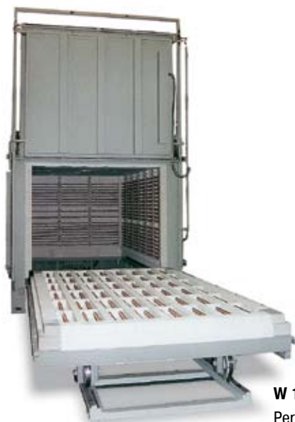
W 8200/S con porta sollevabile in versione realizzata su misura
