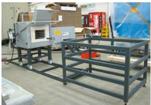
Forno a camera N 61/H a due porte. Dopo il caricamento il forno viene spostato su rotelle sopra la carica in direzione della porta.
