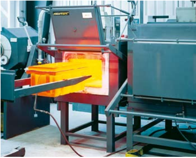
Nitrurazione a polvere in cassetta di cementazione
