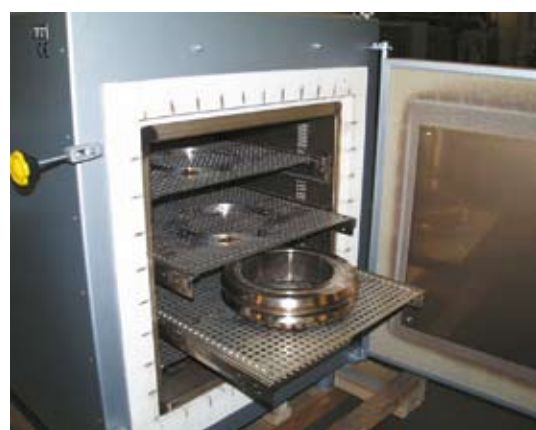
Vano forno con griglie di caricamento in un forno a convezione. I ripiani inseribili sono realizzati su guide telescopiche e possono pertanto essere estratti singolarmente.
