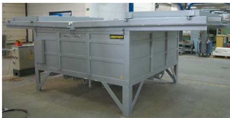
Forno a pozzo S 6200/AS con convezione verticale
