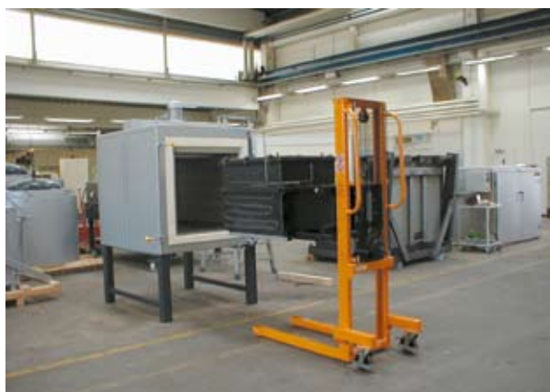
Carrello con sollevamento manuale a fune per cassette ricottura (vedi anche pagg. 12, 22 e 23).
