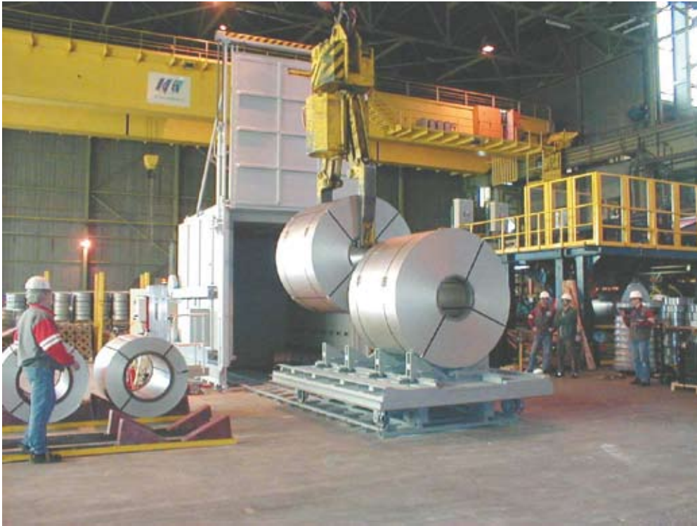
Forno a suola mobile W 21875/26AS in versione personalizzata per il preriscaldamento di bobine di lamiera del peso complessivo di carica massimo di 50 t
