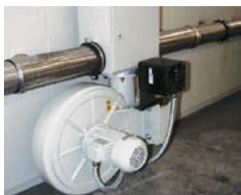
Ventola di raffreddamento per accorciare i tempi di processo
