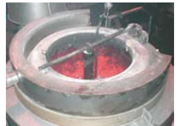
Impianto a bagno di sale per ricottura di componenti in alluminio per l'industria aeronautica
