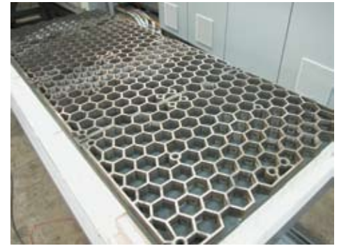
Griglia d'acciaio sul carrello del forno a suola mobile per il caricamento di carichi elevati
