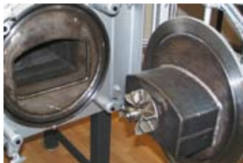
Circolazione del gas nel modello N 41/MA
